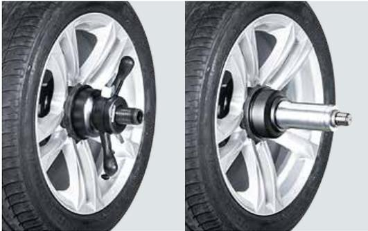
**Option 2: Flansch:** mechanische oder pneumatische Radaufspannung
