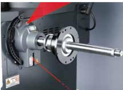
**Pneumatischer Flansch:** Einfach ...
